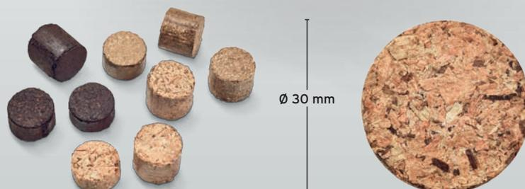
La toute nouvelle **presse RUF Briklet** produit des briquettes d'un diamètre de 30 mm. Ainsi, elles sont transportables dans des alimentations automatiques. De plus, elle s'adapte automatiquement à différentes granulométries. Vous pouvez donc traiter, outre le bois, d'autres matériaux sans problème. Avec les copeaux de bois, la presse RUF Briklet atteint un débit d'env. 300 kg/h pour une densité de briquette  $\geq 1$  kg/l.
